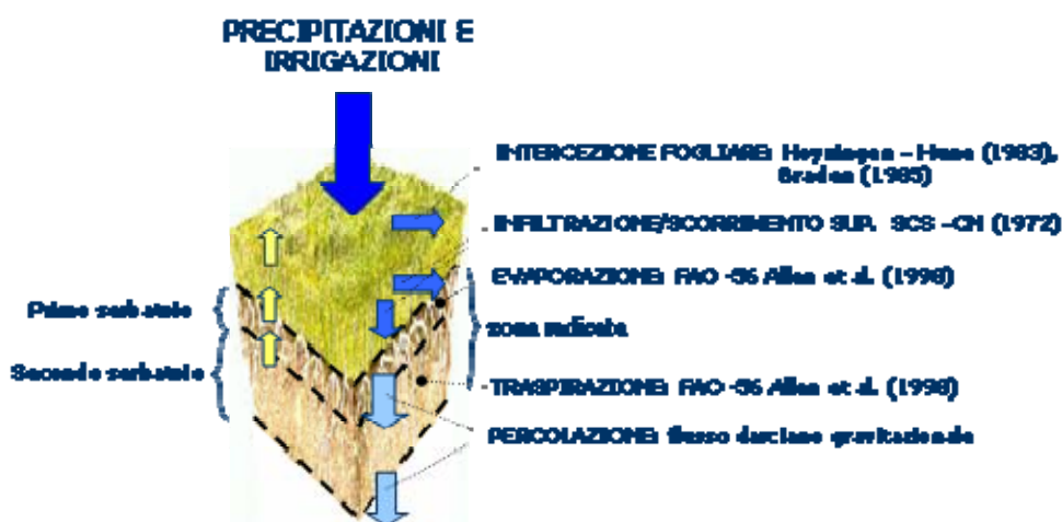
Figura 16. Descrizione dei processi fisici che interessano lo spessore insaturo del suolo, compreso tra il piano campagna e la superficie freatica. I riferimenti bibliografici indicano le principali fonti utilizzate per la modellizzazione dei singoli processi.
