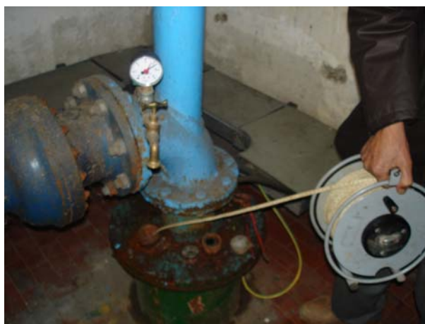
Figura 142. Misurazione del livello statico nel pozzo di via Terni.
